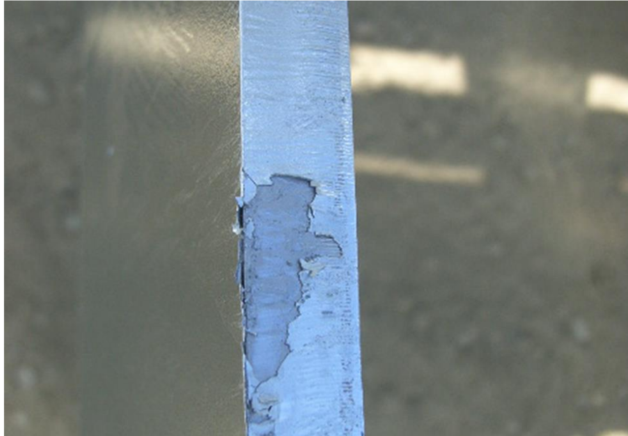
Découpage d'une pièce : défaut pouvant être constaté après galvanisation
