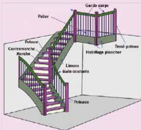
Structure d'un escalier
